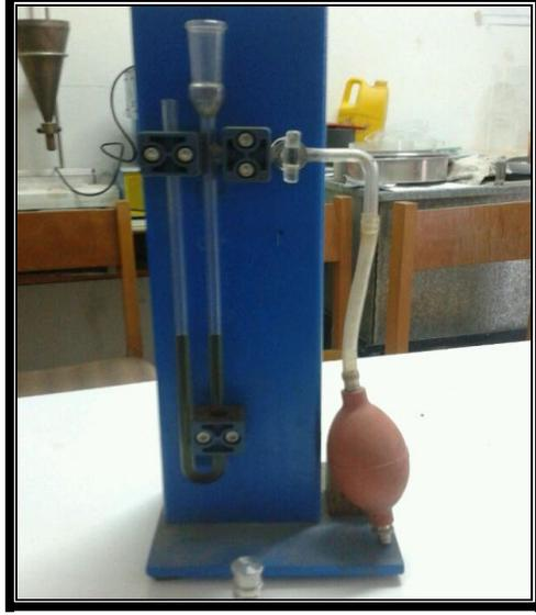
الشكل (3-2) جهاز بلين لقياس السطح النوعي للإسمنت.
